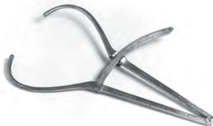
Fig. 12 – Craneómetro de Infocefalia. Diseñado por el Ingeniero David Verde, aporta importantes modificaciones al clásico cefalómetro de Bertillon. No solo por sus dimensiones, mas fácilmente manejable, y por su bajo coste, sino por la aplicación de conceptos matemáticos que corrigen la medición de fragmentos de circunferencia, como hace el Bertillon, convirtiéndolos en medidas lineales equiparándolas a las obtenidas sobre fotografías, recurso habitual en neurocirugía, transformándolo en una herramienta indispensable para el seguimiento en la Atención Primaria.
